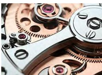
Le polissage plat permet d'obtenir une surface polie miroir grâce au rodage délicat d'une pièce à usiner avec une pâte à polir diamant, à l'aide de mouvements en huit.
