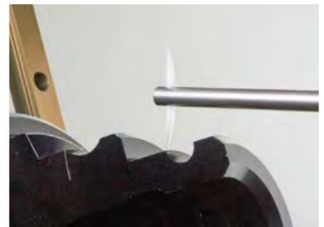
Wahlweise sind je nach Anwendung Tastspitzen sowohl in Ultrafeinkorn Hartmetall oder High-Tech Keramik verfügbar.
