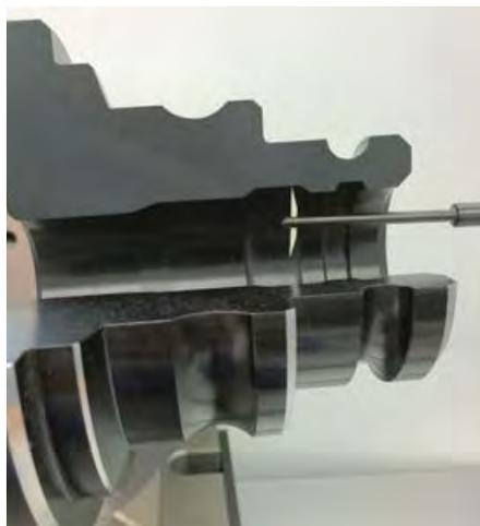
Durch die Messrichtungsumschaltung ist die Abtastung von Oberflächen in zwei Richtungen möglich. Dadurch können ohne Verlust des Messbezuges Innen- und Aussenkonturen zueinander bewertet werden. Diese Funktion ist ohne Einschränkungen in automatisch ablaufenden Messprogrammen verwendbar.
