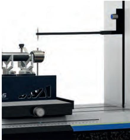
Zur Zenitsuche steht ein effizienter 3D-Suchalgorithmus für die automatische Umkehrpunkt-Bestimmung an Innen- und Aussengewindelehren zur Verfügung. Diese ist für eine genaue Ausrichtung, insbesondere bei kleinen Aussen- und Innengewinden unverzichtbar.
