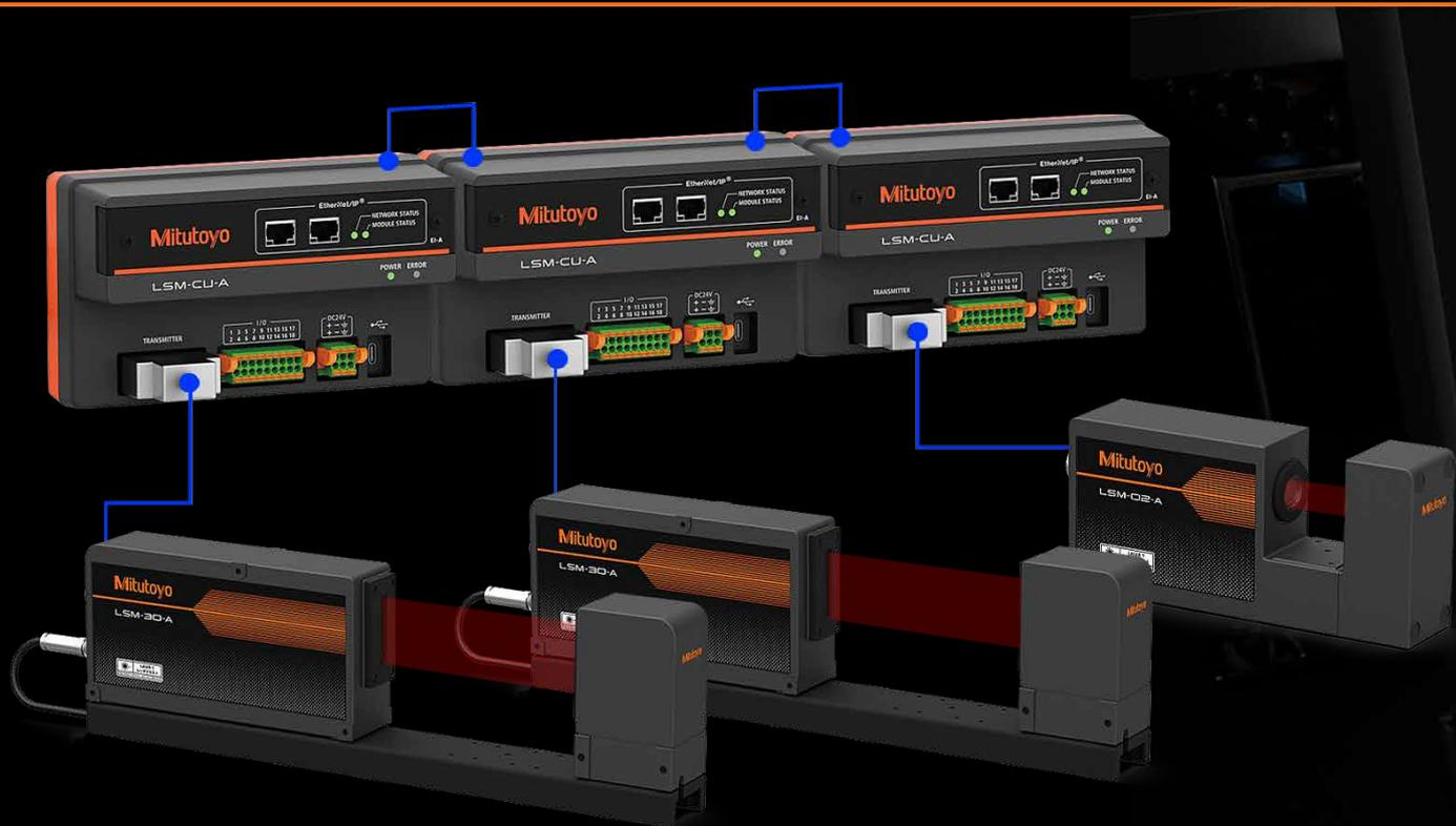
Modulare und Daisy-Chain-fähige Controller mit industriellen Schnittstellen
