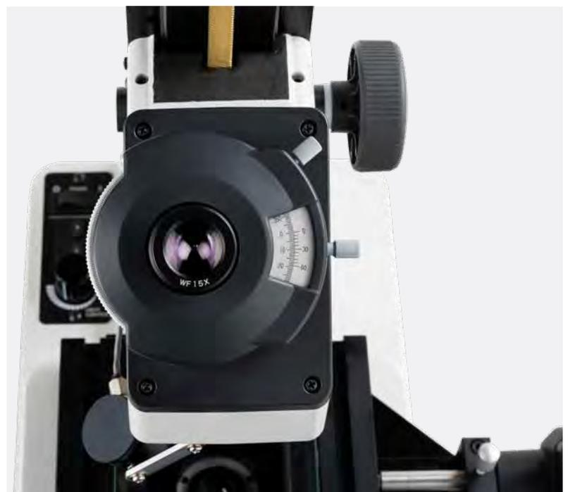
Eine ausserhalb des Okulars angebrachte Nonius-Skala ermöglicht eine einfache Winkelmessung.
