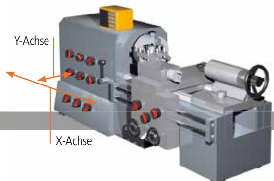
2-Achsen-KA-200-COUNTER + zwei Massstäbe, max. effektiver Messbereich 2'000 mm
