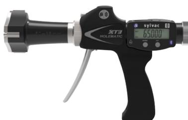
**Xtreme 3 BT** – Équipé de têtes de mesure interchangeable pour des conditions de travail très contraignantes. L'élément de mesure avec poignée pistolet permet un centrage rapide lors de la mesure d'alésages traversants et d'alésages borgnes (à partir de  $\varnothing$  12.5 mm).
