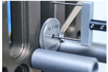
**Softwareoption zur Auswertung der Kennwerte von Gewindelehren und Werkstückgewinden. Verwendbar mit TS-X/TS-UD/TS-UDR/T3/T1/T1-R.**
