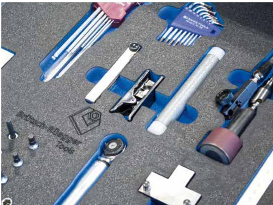
Le scanner mobile Shadowboards de Brütsch/Rüeggli Tools permet d'effectuer des sélections d'outils et de déterminer leur emplacement selon leur fréquence d'utilisation.
