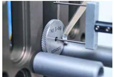
**Option logicielle pour l'évaluation des valeurs caractéristiques des jauges de filetage et des filetages de pièces. Utilisable avec TS-X/TS-UD/TS-UDR/T3/T1/T1-R. Ces systèmes sont parfaits pour une utilisation dans des laboratoires de calibrage certifiés DIN EN ISO/CEI 17025:2018-03 et également dans le domaine de la fabrication en série.**
