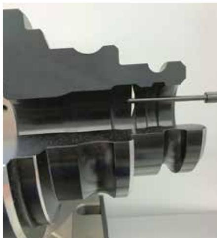
La commutation de la direction de mesure permet de palper les surfaces dans deux directions. Cela permet d'évaluer les contours intérieurs et extérieurs les uns par rapport aux autres sans perte de la référence de mesure. Cette fonction peut être utilisée sans restrictions dans les programmes de mesure qui se mettent automatiquement en marche.
