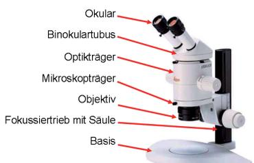
**Komponenten eines Stereomikroskops (GREENOUGH)**
