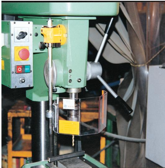
Sicherheitsvorrichtung für Bohrmaschinen
