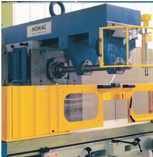
Sicherheitsvorrichtung für Fräsmaschinen
