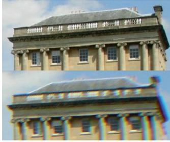
Linsensysteme aus unterschiedlichen Gläsern haben unterschiedliche Brechkraft und entsprechend unterschiedliche chromatische Aberration.
